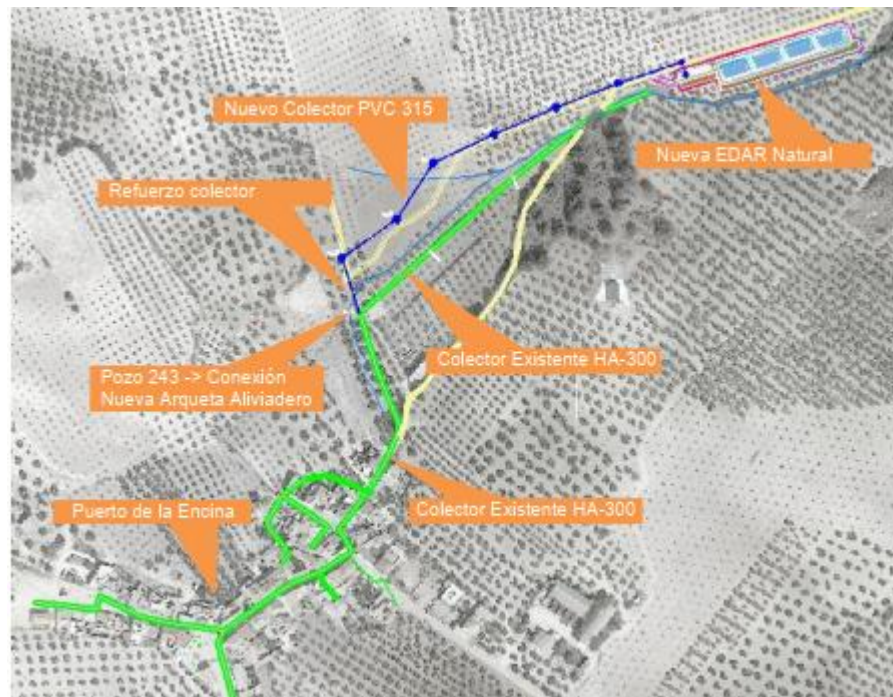
Nuevo colector proyectado
