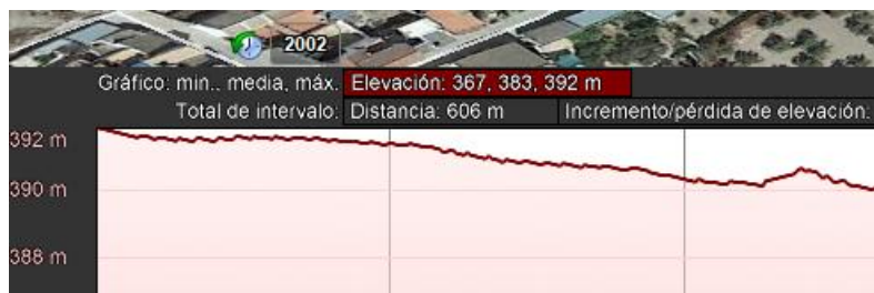
FIGURA 11: ALTERNATIVA 1. PERFIL DEL TERRENO - COLECTOR
