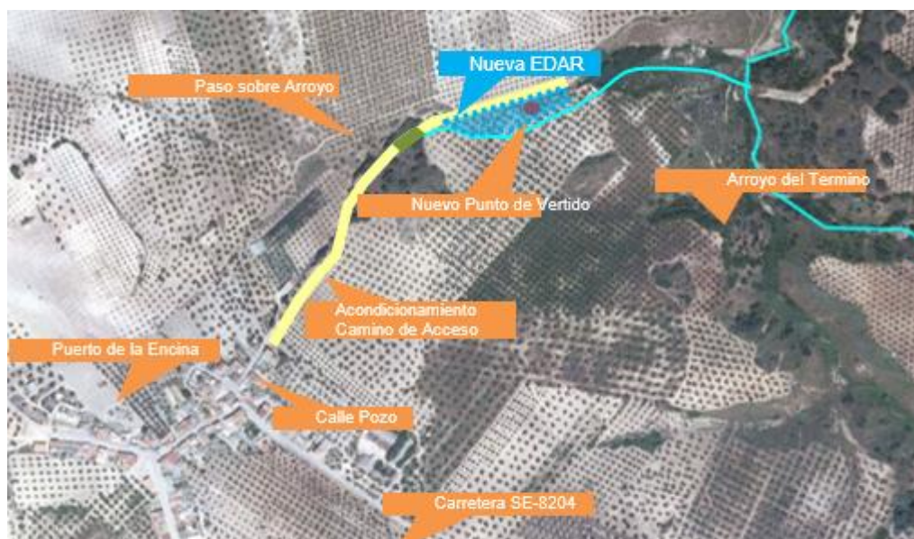
FIGURA 4: ACCESO A LA EDAR
