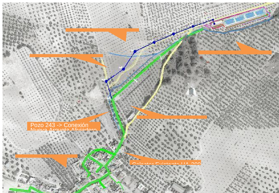
FIGURA 4: NUEVO COLECTOR PROYECTADO
