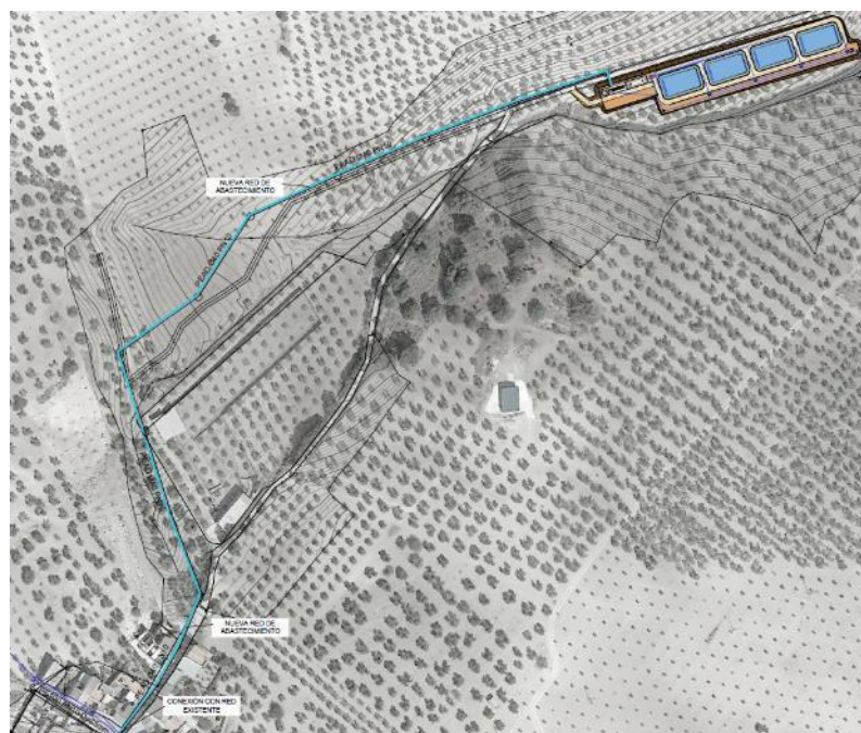
FIGURA 5: NUEVA ACOMETIDA ABASTECIMIENTO PEAD D40
