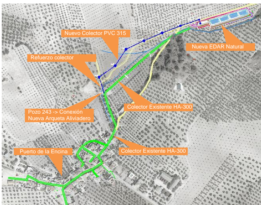
FIGURA 4: NUEVO COLECTOR PROYECTADO
