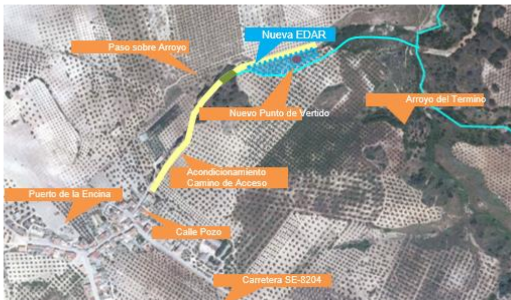
FIGURA 16: ACCESO A LA EDAR
